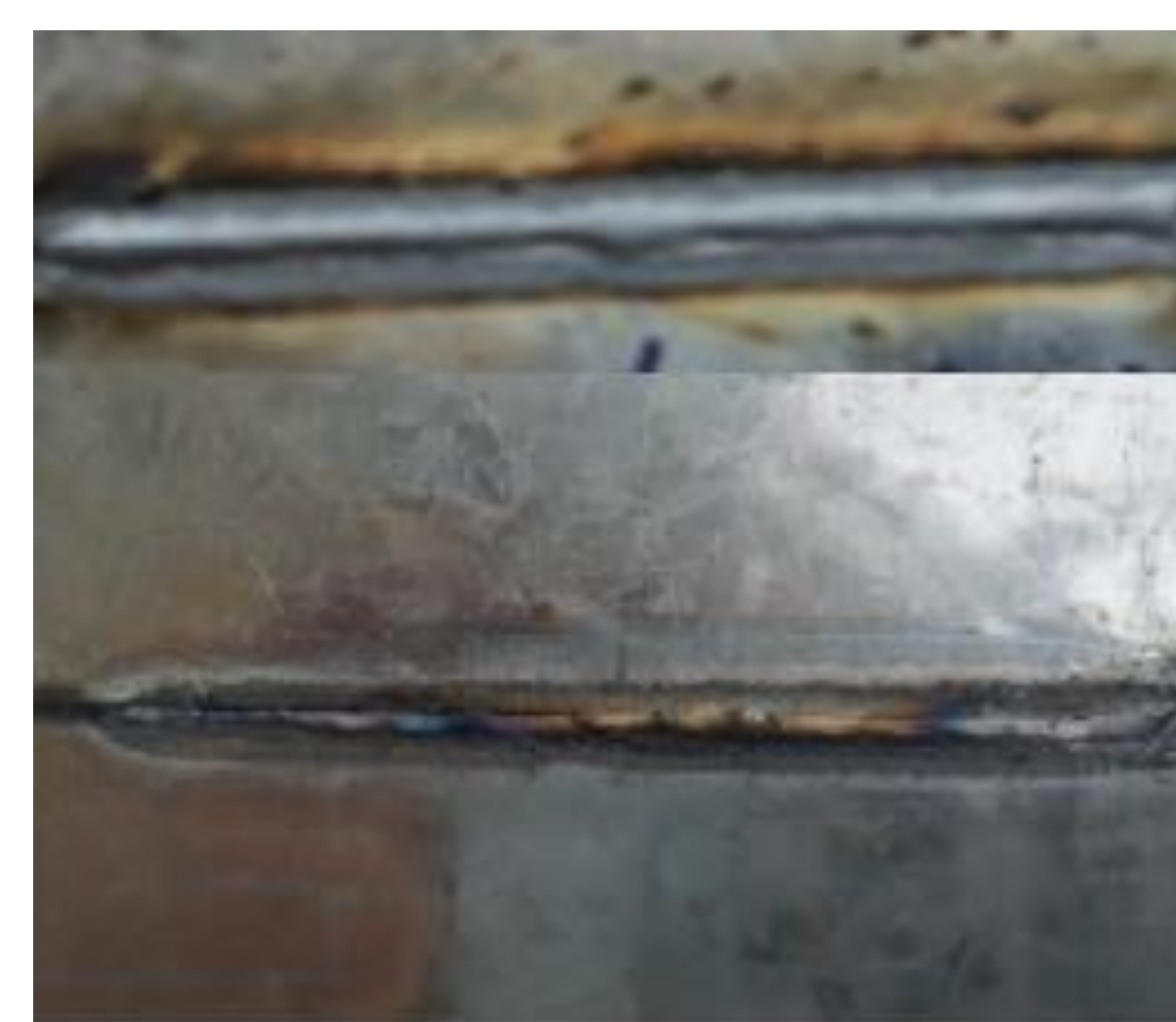
图1 焊接接头表面形貌
